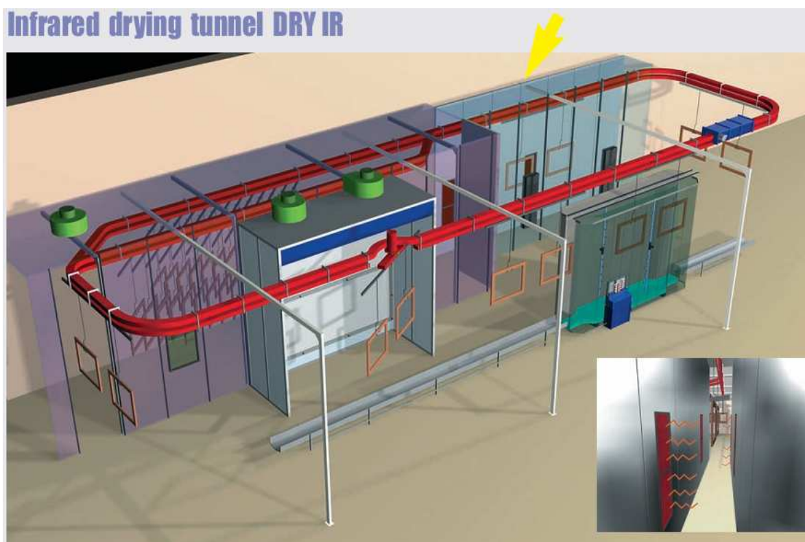
Figura 2.9- Tunnel di essiccazione a infrarossi
